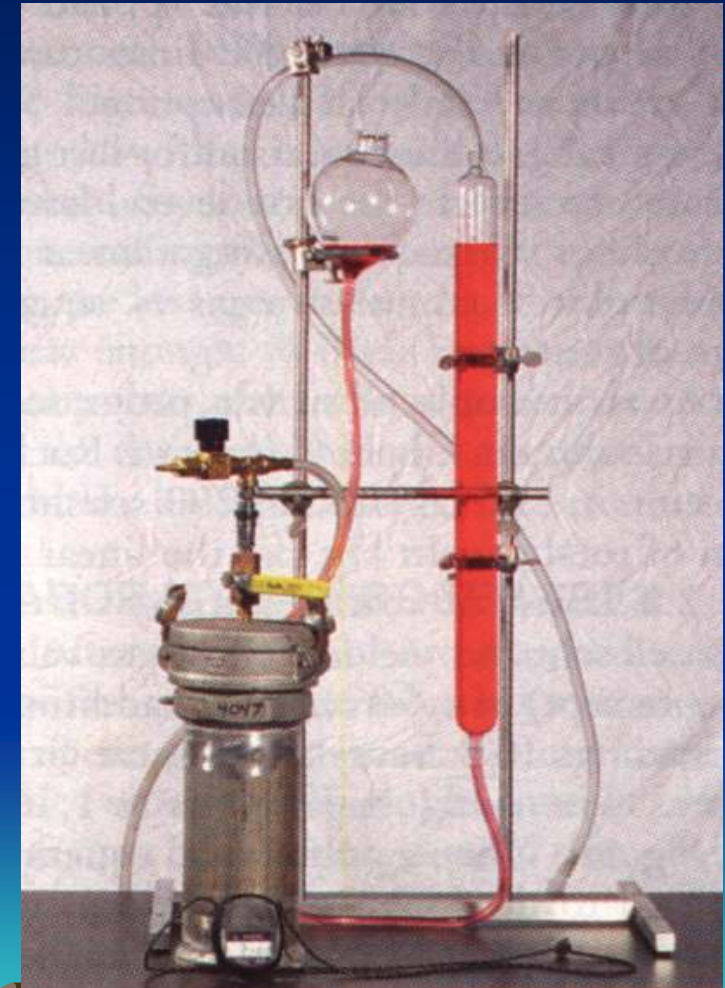
Apparato classico per la misura del CBM producibile
