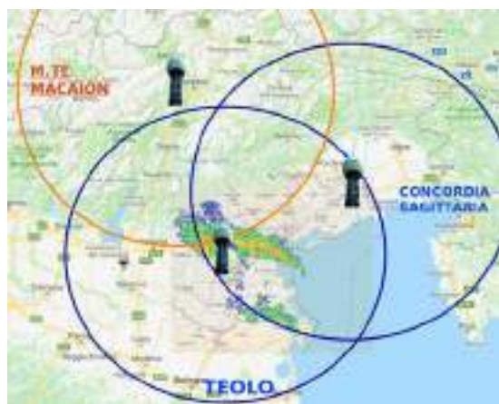
Figura 1: Cerchi di visibilità dei radar impiegati per il servizio ARPAV Temporalis
