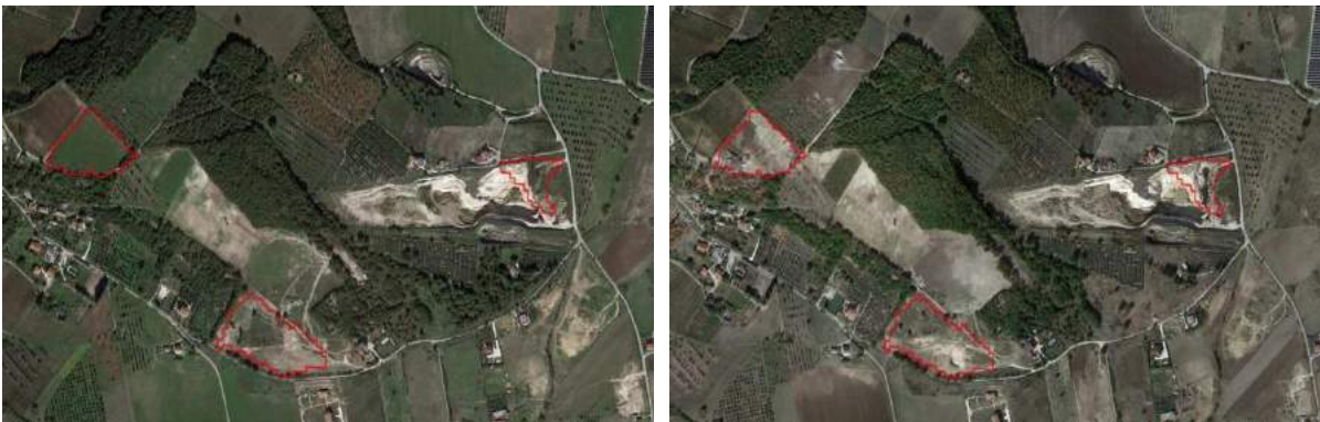
Figura 90 - Il cambiamento della copertura del suolo di Benevento riguarda principalmente la creazione di parcheggi, l'espansione di una cava in zona Contrada San Giovanni e l'ampliamento di zone ad uso logistico, per un totale di 8,2 ettari di suolo consumato. Alcune aree precedentemente ad uso agricolo, inoltre, risultano ora sterrate.
